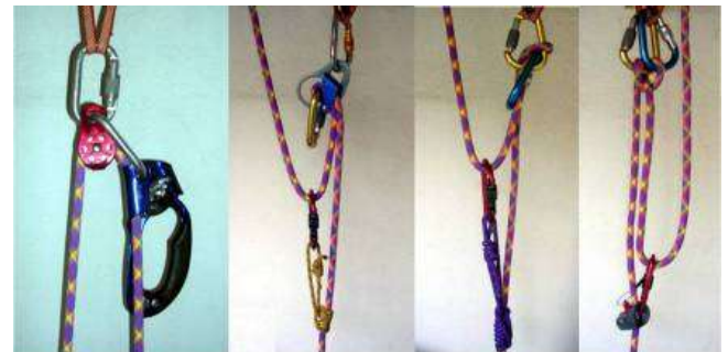
Con Reverso y nudo prusik - Con nudo Lorenzi y machard - Con nudo Remy y un ropeman
